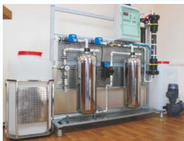
Установка получения гипохлорита натрия
